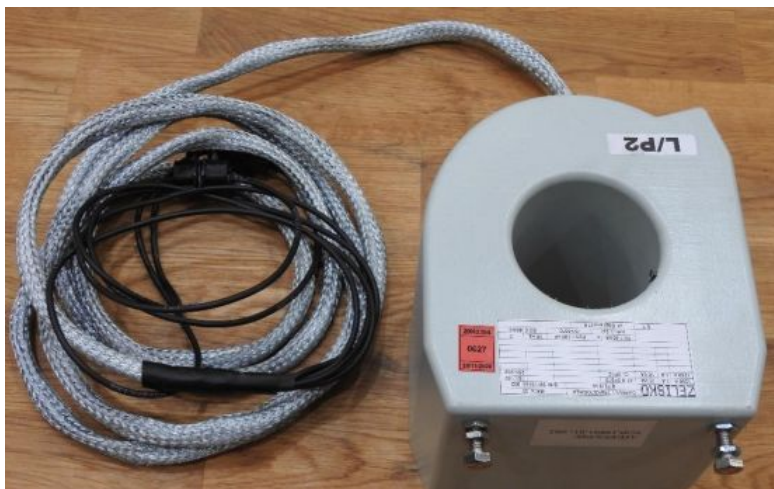
1 pav. Srovės matavimo transformatoriaus bendras vaizdas
